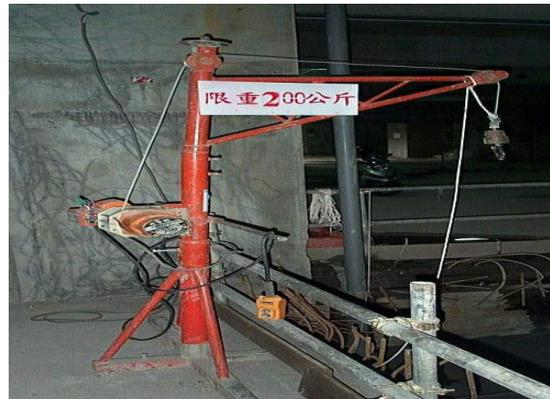
起重機具應標示最高負荷，並設置吊物防脫落裝置及過捲預防裝置等安全裝置。
