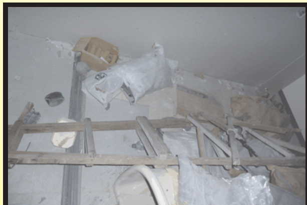
合梯第1、2階已斷裂，未有堅固之構造、材質有顯著之損傷、兩梯腳間未有繫材扣牢、無安全之梯面。
